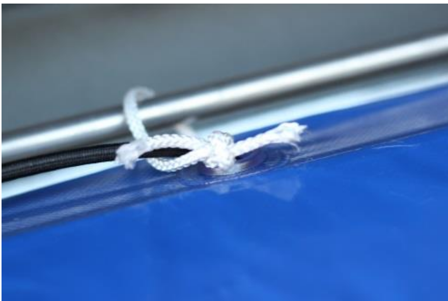
Her ses presenning og aksel forbundet med snor uden spændebånd.
